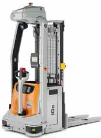
von bis zu 1600 Kilogramm, kann Waren bis zu 3,8 Meter anheben und erreicht eine beachtliche Geschwindigkeit von bis zu 2 m/s. Die schnelle Inbetriebnahme in Kombination mit einer neuen, intuitiven Bedienoberfläche mache den serienbasierten Mobile Robot vor allem für KMU zum smarten Türöffner in die Welt der automatisierten Lagerprozesse, urteilt die Jury.
