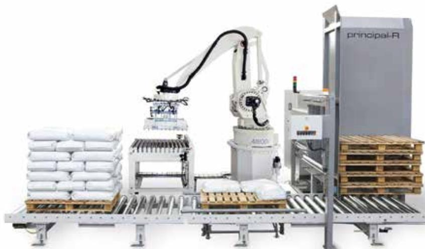
*Die Hochlagen-, Portal- und Robot-Palettierer von STATEC BINDER ermöglichen eine effiziente Palettierung von Säcken oder Kartons*
