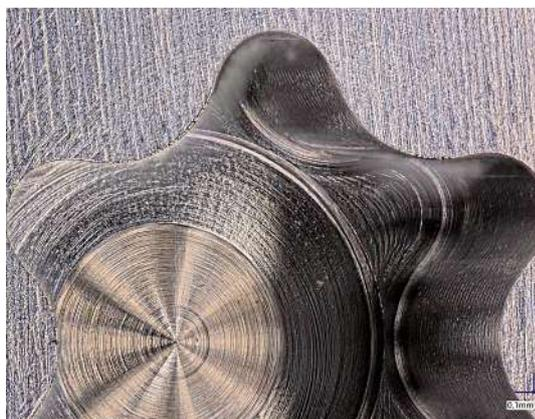
Usinage dans du titane grade 2 avec un outil non revêtu après la réalisation de 819 empreintes sur micro-centre d'usinage.
