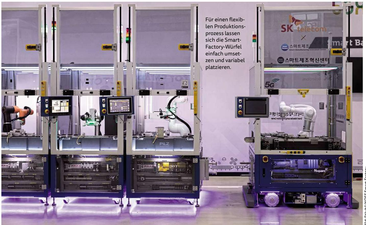
Für einen flexiblen Produktionsprozess lassen sich die Smart-Factory-Würfel einfach umsetzen und variabel platzieren.
