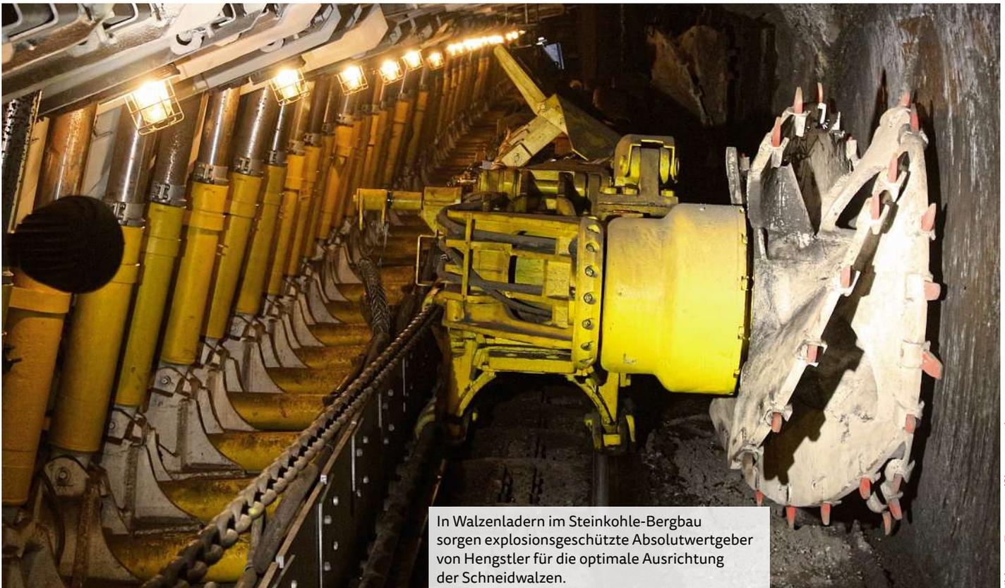
In Walzenladern im Steinkohle-Bergbau sorgen explosionsgeschützte Absolutwertgeber von Hengstler für die optimale Ausrichtung der Schneidwalzen.
