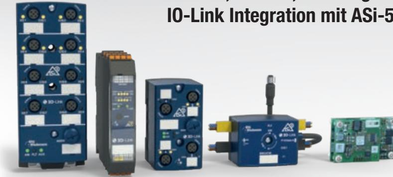
Die Anbindung von IO-Link Devices an die Steuerungsebene bzw. Cloud bietet mit ASI-5 und den ASI-5 Modulen mit integriertem IO-Link Master von Bihl+Wiedemann eine Reihe von Vorteilen. Anwender profitieren bei der feldbusunabhängigen Lösung nicht nur von einer perfekten Einbettung von IO-Link in ASI-5 und in die benutzerfreundlichen Konfigurationstools ASIMON360 und ASi Control Tools360, sondern auch von der Freiheit in der Topologiewahl, einem reduzierten Verdra-
