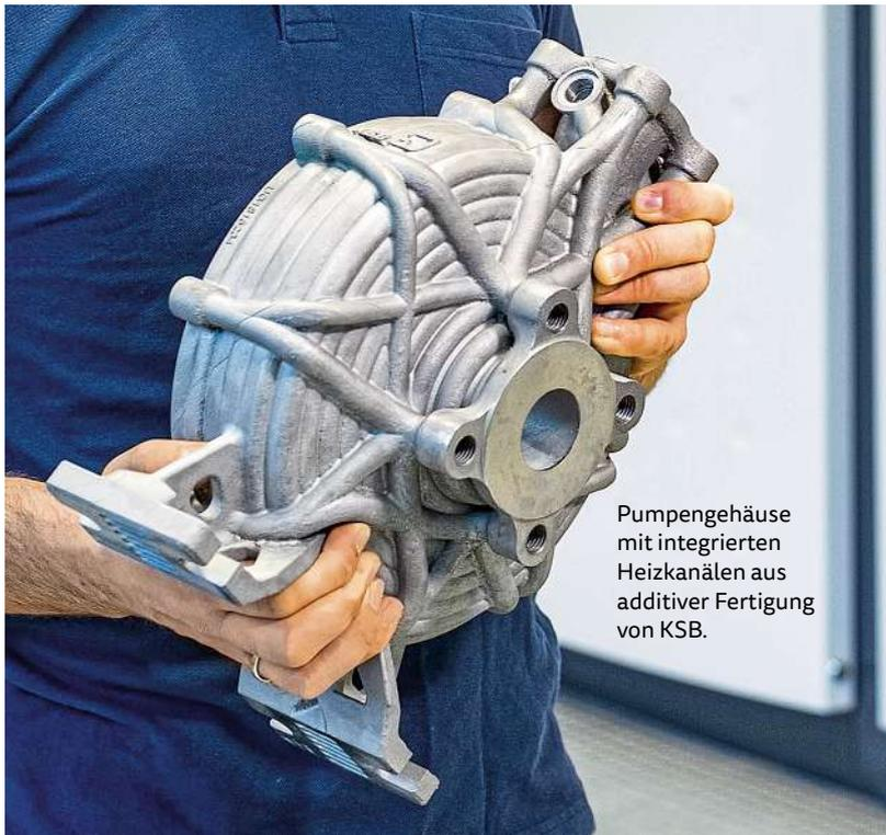
Pumpengehäuse mit integrierten Heizkanälen aus additiver Fertigung von KSB.
