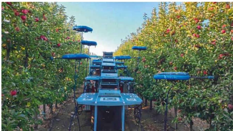
In der Obsternte kann das auf fix angebundene Drohnen basierte Robotersystem von Tevel dem Fachkräftemangel entgegenwirken.
