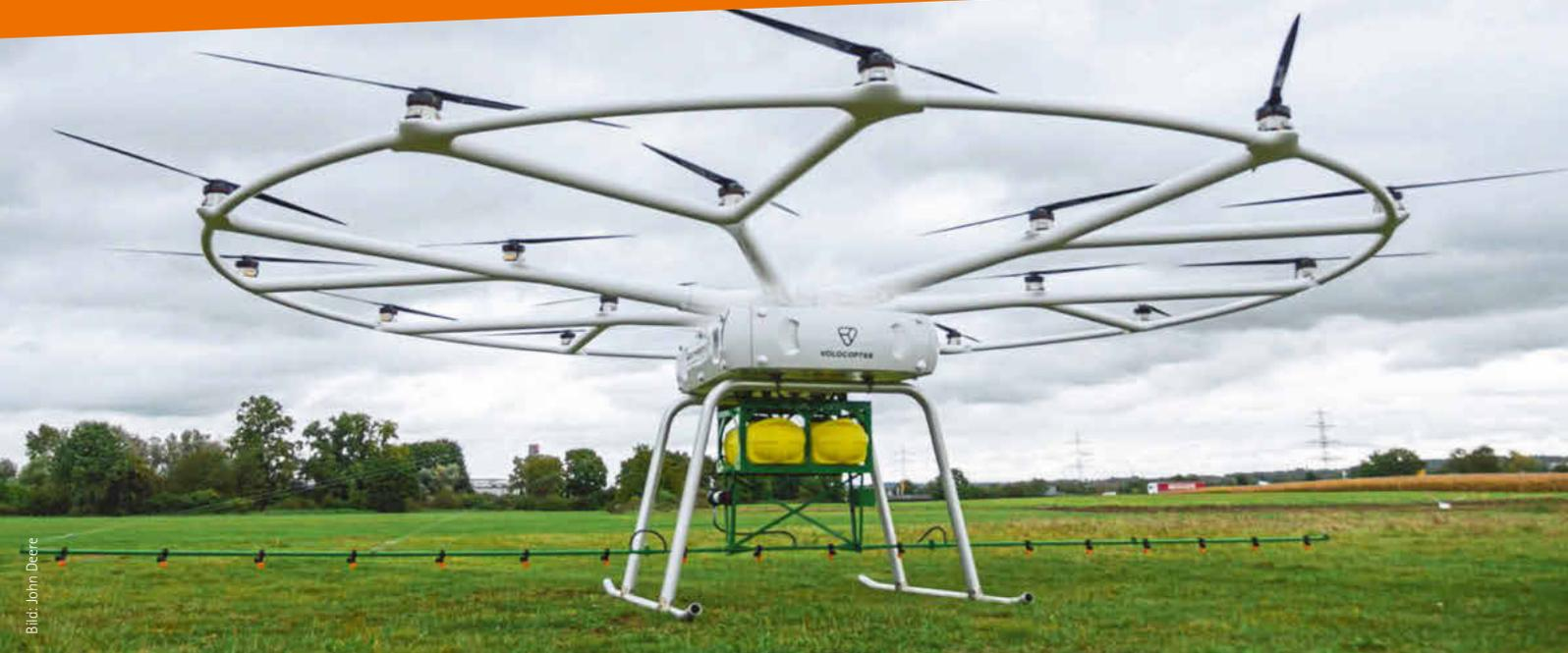
Die von Volocopter und John Deere entwickelte Agrardrohne misst fast 10 m und kann 200 kg tragen.
