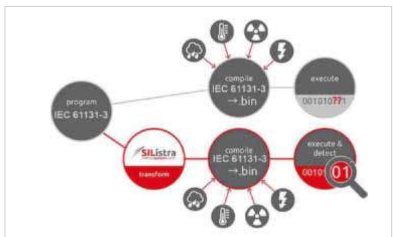
Abarbeitung der Sicherheitsapplikation in zwei getrennten Softwarekanälen mit Coded Processing.
