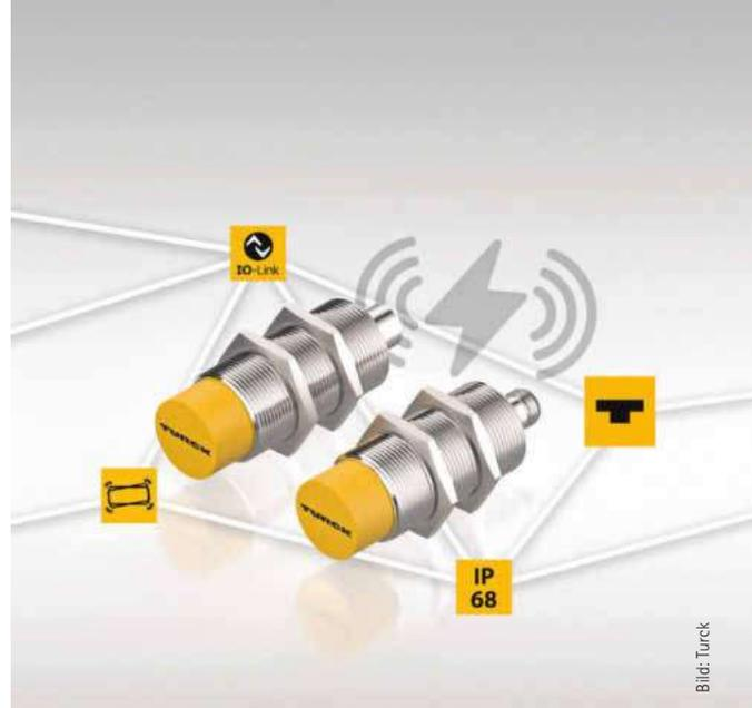
Turcks robuste IO-Link-Koppler widerstehen hohen Schockbelastungen und übertragen 18 W Leistung über eine Luftschnittstelle von 7 mm.
