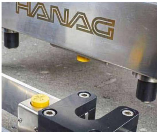
In dieser Applikation übertragen Turcks induktive Koppler berührungslos Leistung und Schaltsignale mobiler Sterilisationsbehälter – die ID des IO-Link-Sensors dient darüber hinaus zur sicheren Identifikation jedes Containers.
