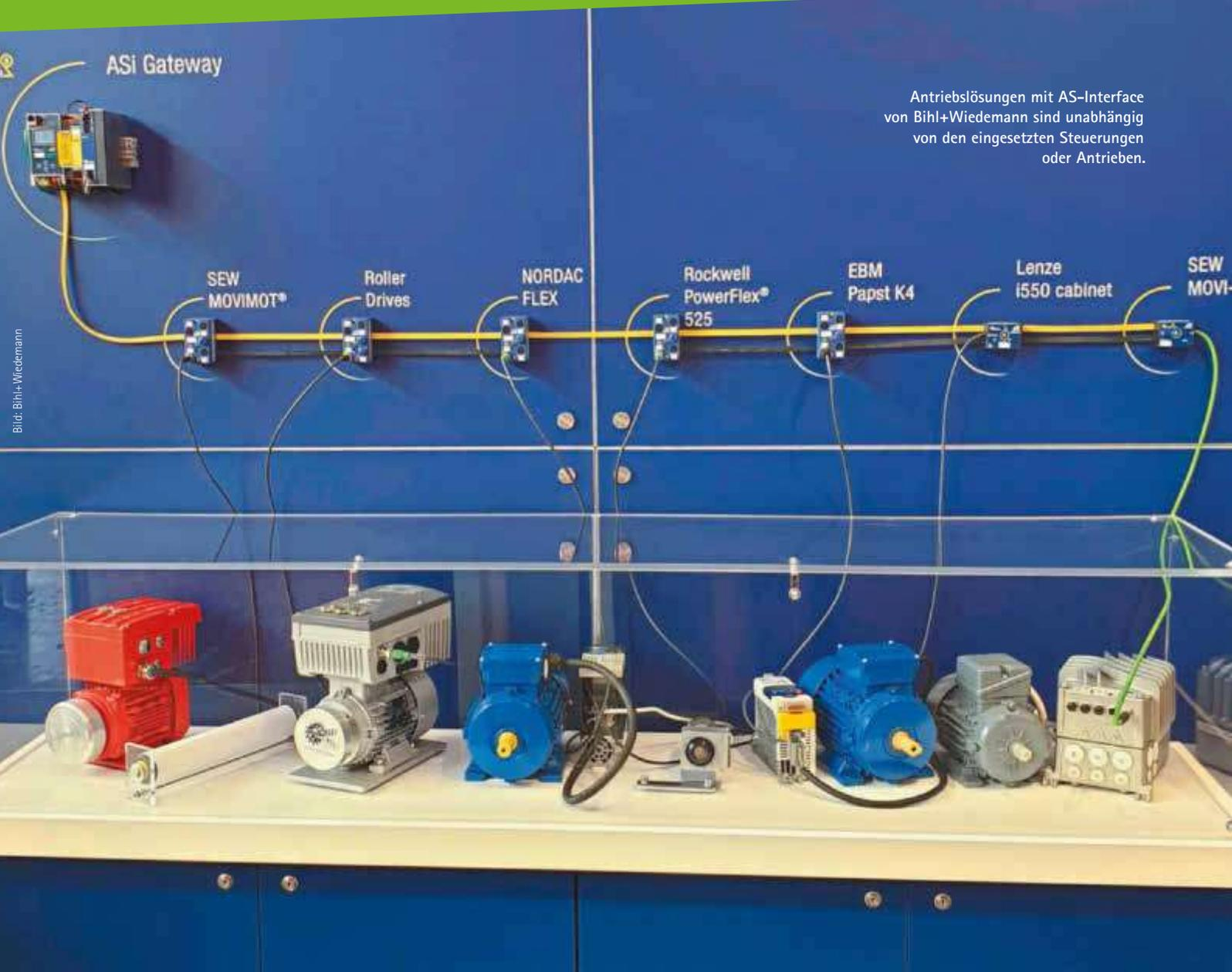
Antriebslösungen mit AS-Interface von Bihl+Wiedemann sind unabhängig von den eingesetzten Steuerungen oder Antrieben.
