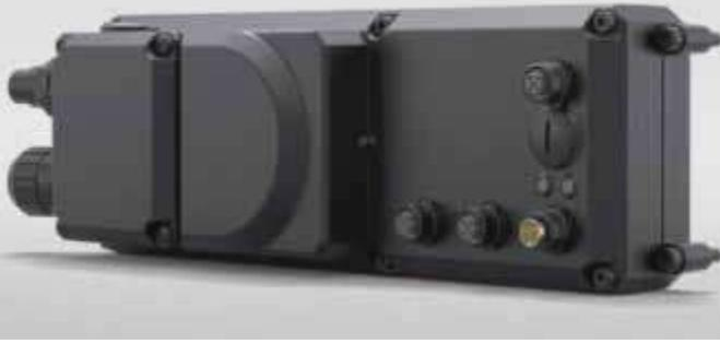
Die je nach Karosserietyp variierenden Abstände zwischen den Aufnahmepunkten des DAP sowie den Hub der Achsen regelt die dezentrale Einspeisung mit integriertem Motion Controller iSA: Sie regelt in der Applikation 18 Servoachsen und kann bis zu sechs Z-Achsen im Master-Slave-Betrieb gleichzeitig ausheben.
