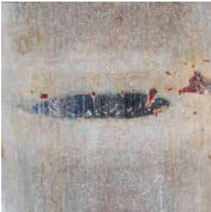
Detailansicht eines Schadensbildes: In der Mitte des False Brinelling bildet sich typischerweise ein augenförmiger Bereich.
