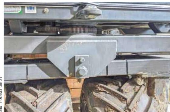
Der Multiturn-Drehgeber WV5800M erfasst den Lenkwinkel an der Lenkeinheit, damit das Fahrzeug seinen definierten Pfad sicher umsetzen kann.
