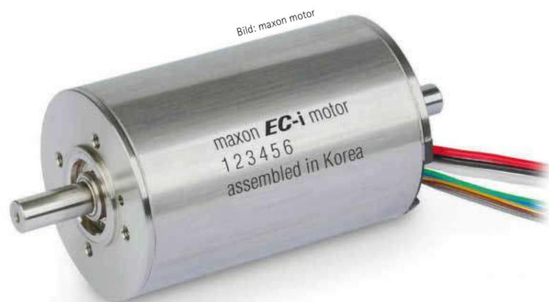
Die bürstenlosen EC-i-Motoren von maxon mit Eisenwicklungen bieten eine sehr hohe Drehmomentdichte und ein tiefes Rastmoment. Der mehrpolige Innenläufer ist äußerst dynamisch. Durch seine solide Bauweise mit Stahlflansch und -gehäuse eignet sich dieser Motor für eine Vielzahl von Anwendungen.
