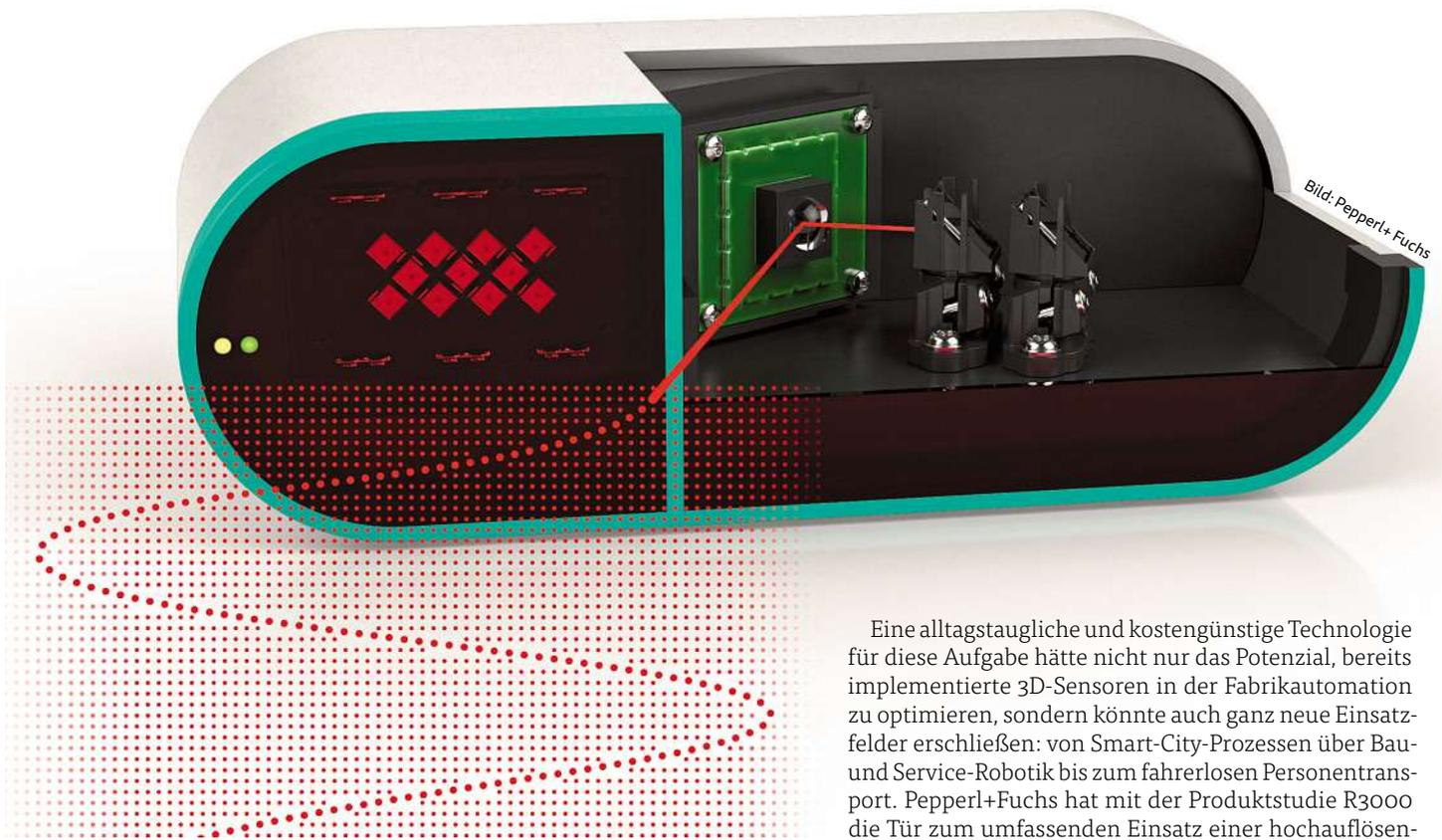
Blick ins Innere: Die Produktstudie R3000 von Pepperl+Fuchs kombiniert die Pulse Ranging Technology (PRT) mit einem mikroelektromechanisch bewegten Spiegel. Damit wird eine hochgradig robuste Lösung erreicht.
