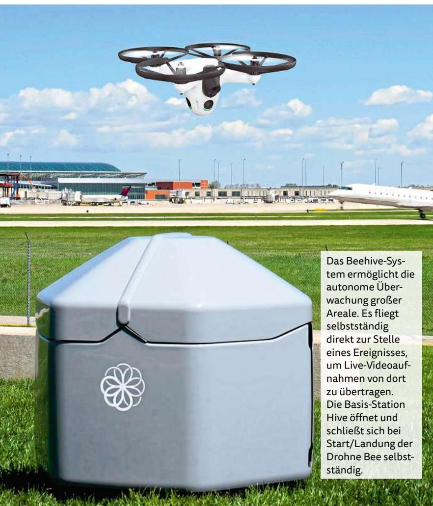
Das Beehive-System ermöglicht die autonome Überwachung großer Areale. Es fliegt selbstständig direkt zur Stelle eines Ereignisses, um Live-Videoaufnahmen von dort zu übertragen. Die Basis-Station Hive öffnet und schließt sich bei Start/Landung der Drohne Bee selbstständig.
