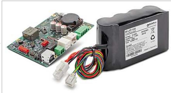
Die intelligente DC-USV Bicker UPSI-2406 (144 W / 24 V / 6 A) mit LiFePO4-Batteriepack Bicker BP-LFP1325 (13,2 V / 2,5 Ah / 33 Wh) schützt 24V-DC-Applikationen bei Stromausfall, Spannungseinbrüchen oder Flicker.
