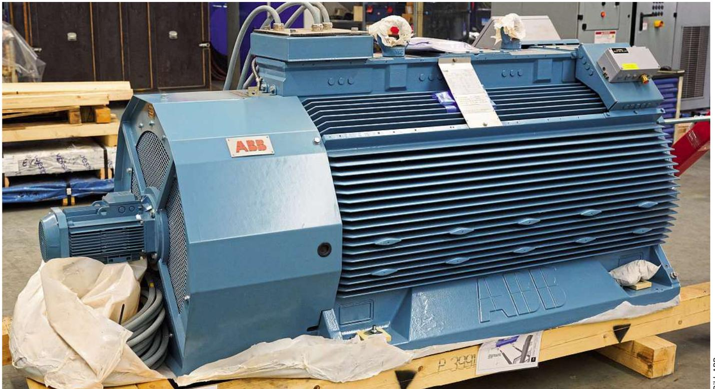
Die ABB-Hochspannungsmotoren müssen extrem kurze Beschleunigungs- und Bremszeiten realisieren können.
