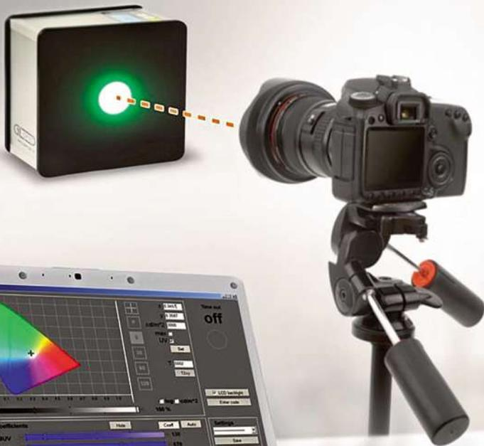
**Kamera kalibrieren:** Mit einer speziellen Software lassen sich beliebige Farbkoordinaten aus einem größeren Farbraum als sRGB einstellen. Zusammen mit einer programmierbaren Referenz-Lichtquelle lassen sich optoelektronische Systeme prüfen und kalibrieren.
