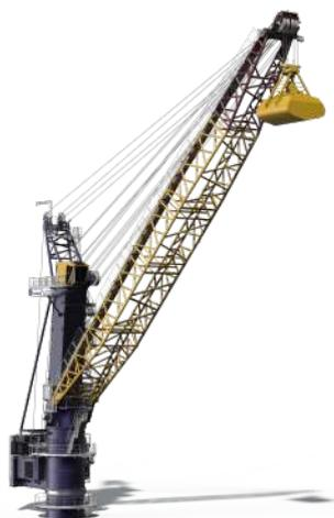
Der jüngst von Liebherr gemeinsam mit dem Hafenunternehmen ZHD in den Niederlanden entwickelte Kran CBG 500 E arbeitet vollständig elektrisch. Er trägt bis 105 t am Lasthaken, bis 90 t am Greifer. Der Kran wird für den Schüttgutumschlag im Raum Rotterdam und in den ZHD-Terminals in Dordrecht und Moerdijk eingesetzt. Er kombiniert aktuelle Antriebstechnologien mit der
