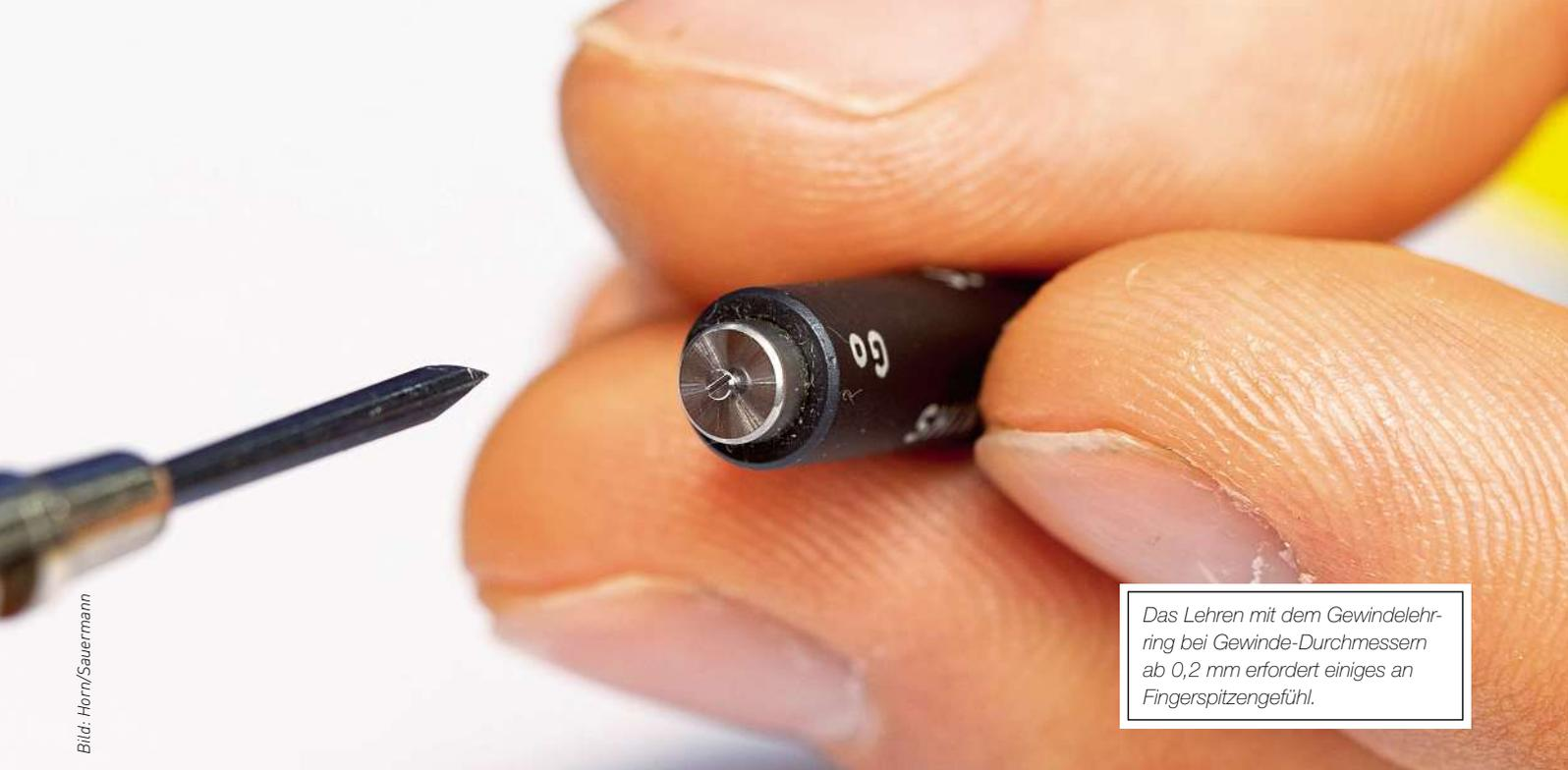
Das Lehren mit dem Gewindelehr-ring bei Gewinde-Durchmessern ab 0,2 mm erfordert einiges an Fingerspitzengefühl.
