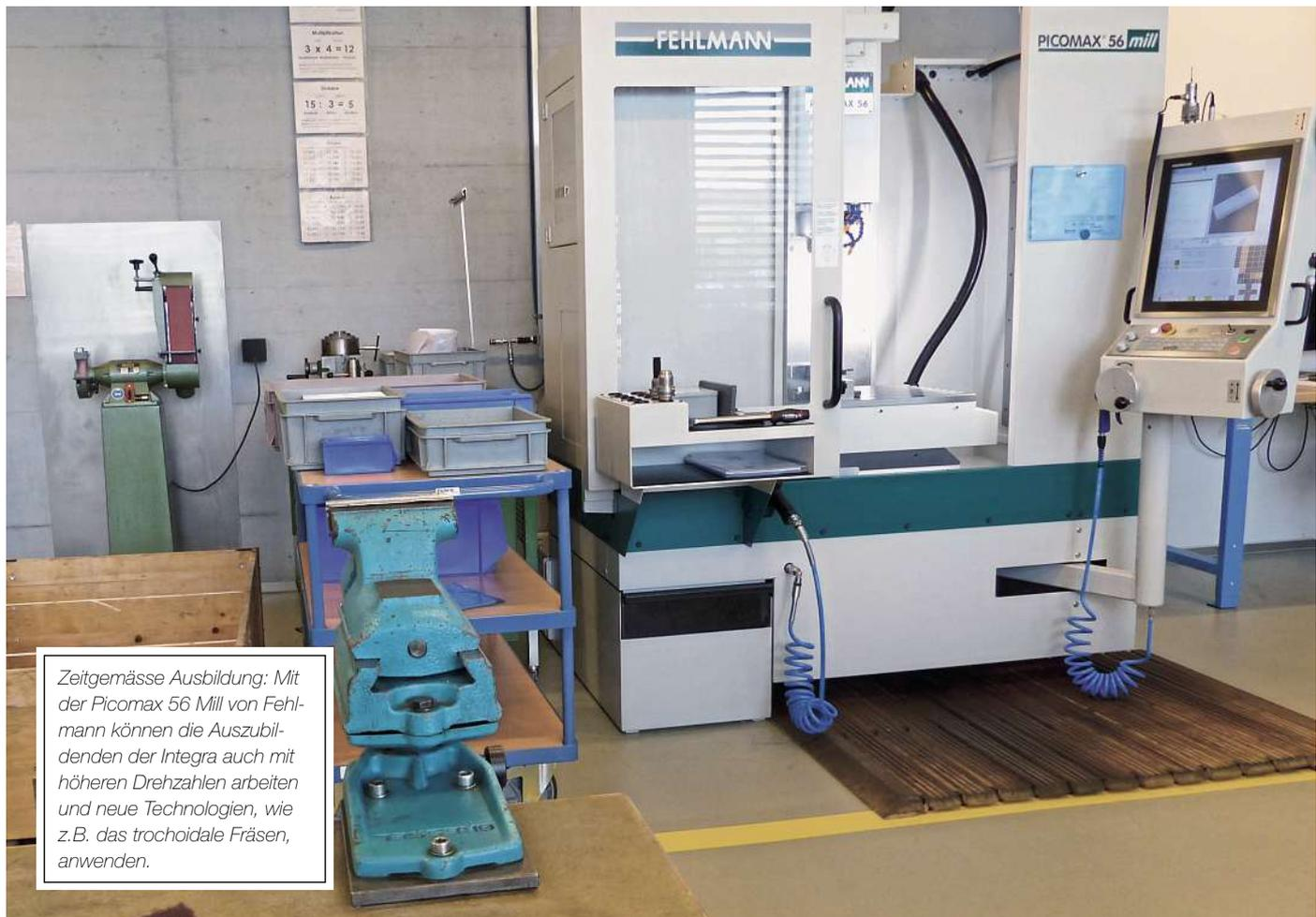
*Zeitgemässe Ausbildung: Mit der Picomax 56 Mill von Fehlmann können die Auszubildenden der Integra auch mit höheren Drehzahlen arbeiten und neue Technologien, wie z.B. das trochoidale Fräsen, anwenden.*
