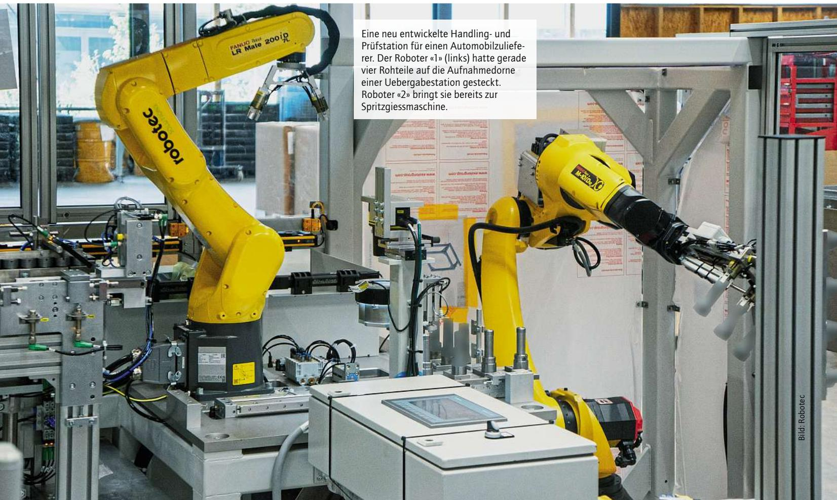
Eine neu entwickelte Handling- und Prüfstation für einen Automobilzulieferer. Der Roboter «1» (links) hatte gerade vier Rohteile auf die Aufnahmezone einer Uebergabestation gesteckt. Roboter «2» bringt sie bereits zur Spritzgiessmaschine.
