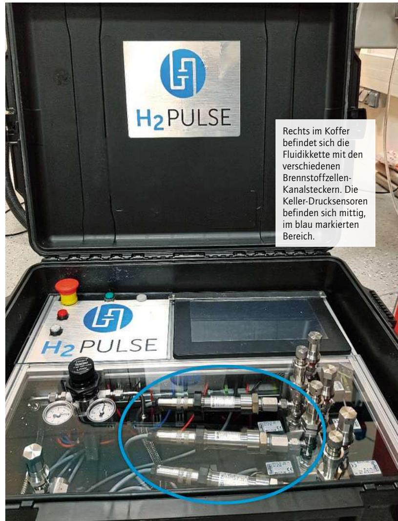
Rechts im Koffer befindet sich die Fluidkette mit den verschiedenen Brennstoffzellen-Kanalsteckern. Die Keller-Drucksensoren befinden sich mittig, im blau markierten Bereich.
