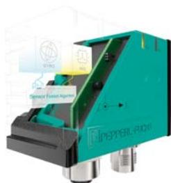
Der **Pepperl+Fuchs** Neigungssensor IMU F99 liefert für den mobilen Einsatz stabile Neigungswerte. Ein integriertes Gyroskop kompensiert Beschleunigungen und macht so eine präzise Neigungsmessung möglich. Dadurch er die deutlich bessere Wahl gegenüber herkömmlichen statischen Nei-
