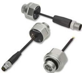
Mit seinem neuen Ultraschall-Positionssensor hat **Balluff** eine innovative Lösung zur Kontrolle hydraulischer Spannelemente entwickelt. Der BFD-Sensor gibt Ultraschallwellen in die Hydraulikflüssigkeit von Kurzhub-Spannelementen wie Schwenkspannern oder Blockzylindern, um direkt, kontinuierlich und schnell den jeweiligen Spannungszustand zu erfassen.
