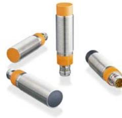
Die neuen Drehzahlwächter von **ifm** arbeiten mit einem induktiven Näherungsschalter, der ein Bedämpfungselement auf einem rotierenden Anlagenteil erfasst. Das Bedämpfungselement kann etwa eine Schraube auf einer Welle sein. Um mit dieser Methode Drehzahlen überwachen zu können, ist in den kompakten Drehzahlwächtern die Auswerteelektronik
