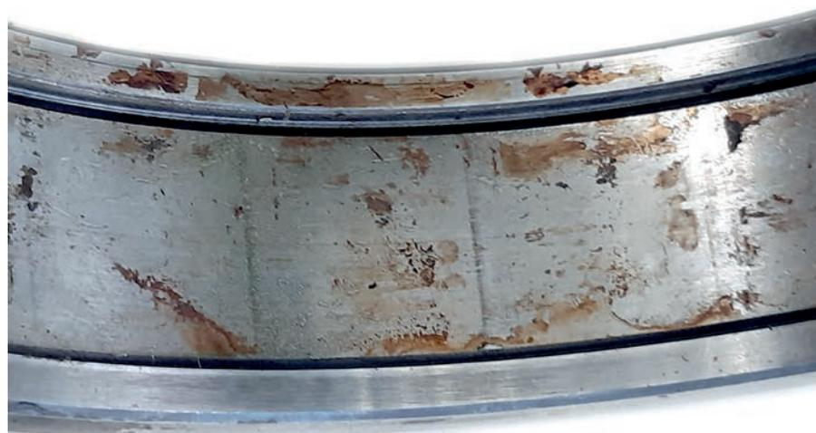
*Beginnende Reibkorrosion an der Außenringlaufbahn eines Zylinderrollenlagers*
