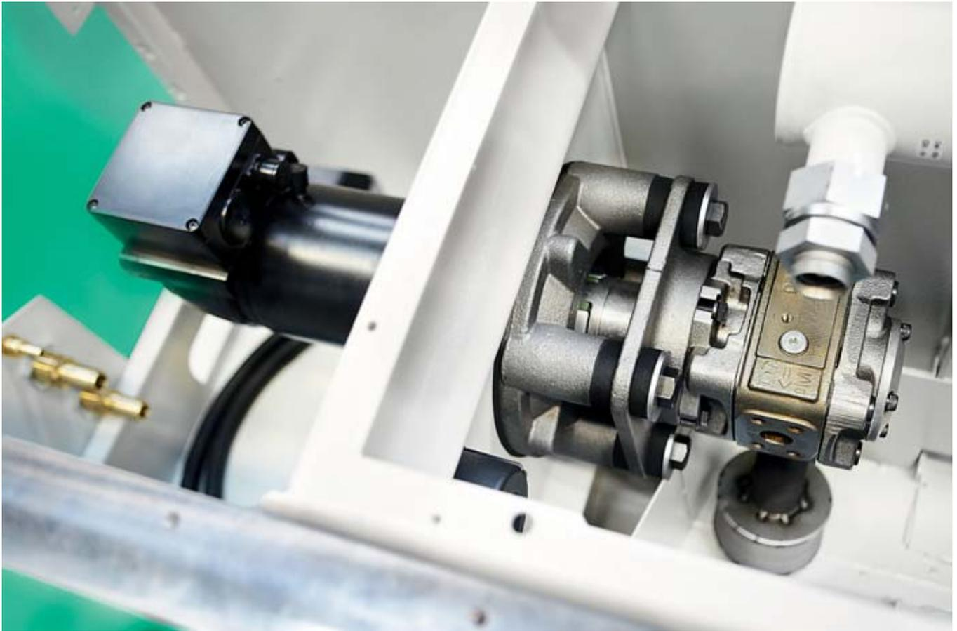
Hydraulische Spritzeinheit: Die hybriden Allrounder H der Leistungsvarianten ‚Comfort‘ und ‚Premium‘. Bilder: Arburg
