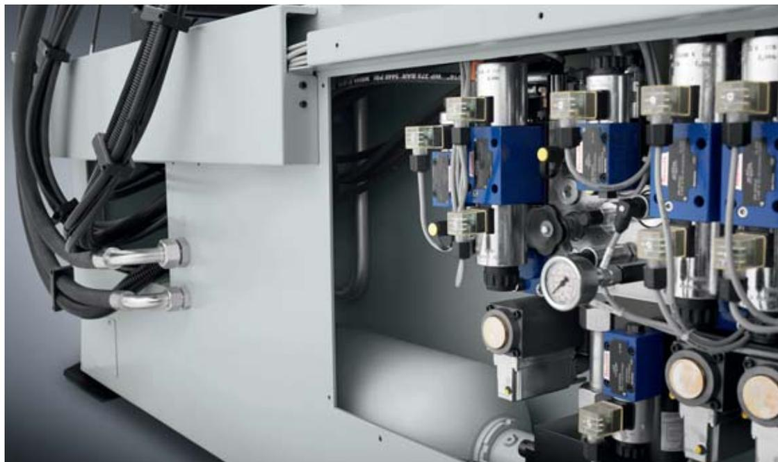
Bei den hybriden Allroundern der Leistungsvariante „Ultimate“ lassen sich mittels Hydraulikspeichertechnik über separate Regelventile alle Achsen unabhängig voneinander bewegen.
