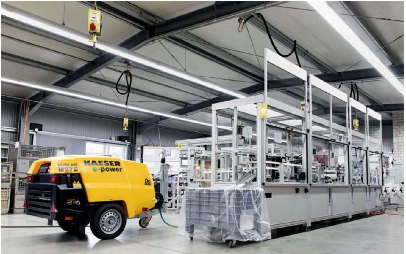
Mobile Baukompressoren mit Elektroantrieb können auch innerhalb von Gebäuden aufgestellt werden, wie es bei Unimatic der Fall war. *Bilder: Kaeser*
