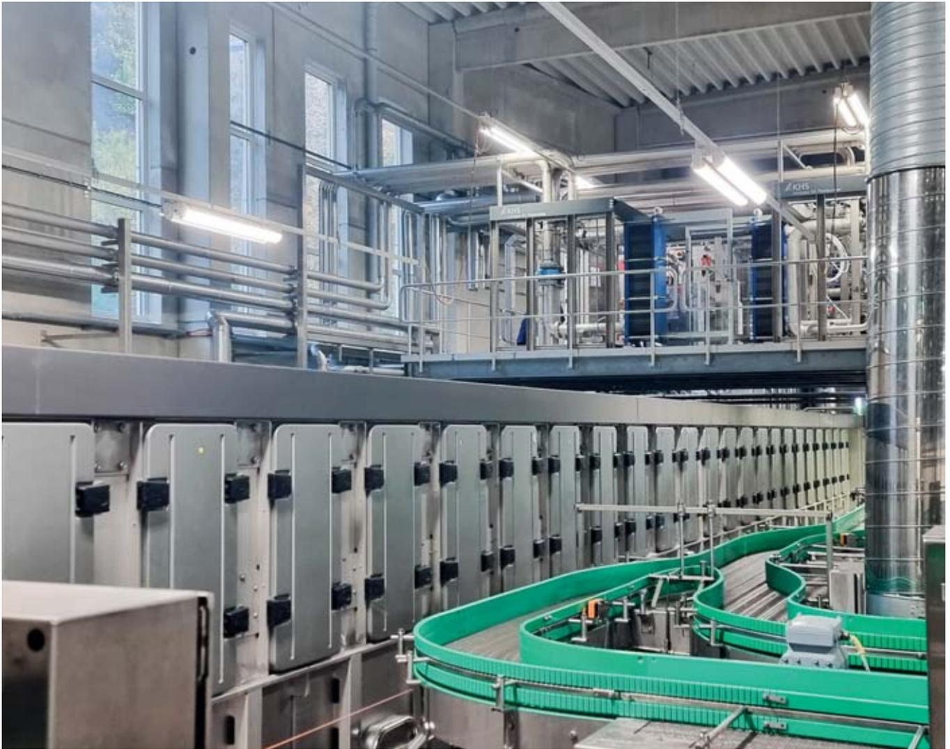
Um Markenprodukte mit höchstem Anspruch zu produzieren, setzt Rhodius auf neueste Technik von KHS – einen hochmodernen Tunnelpasteur.
