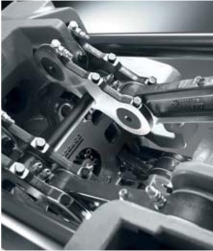
Elektrische und hydraulische Antriebe kombiniert beim Spritzgießen in hybrider Maschine. Bild: Arburg
