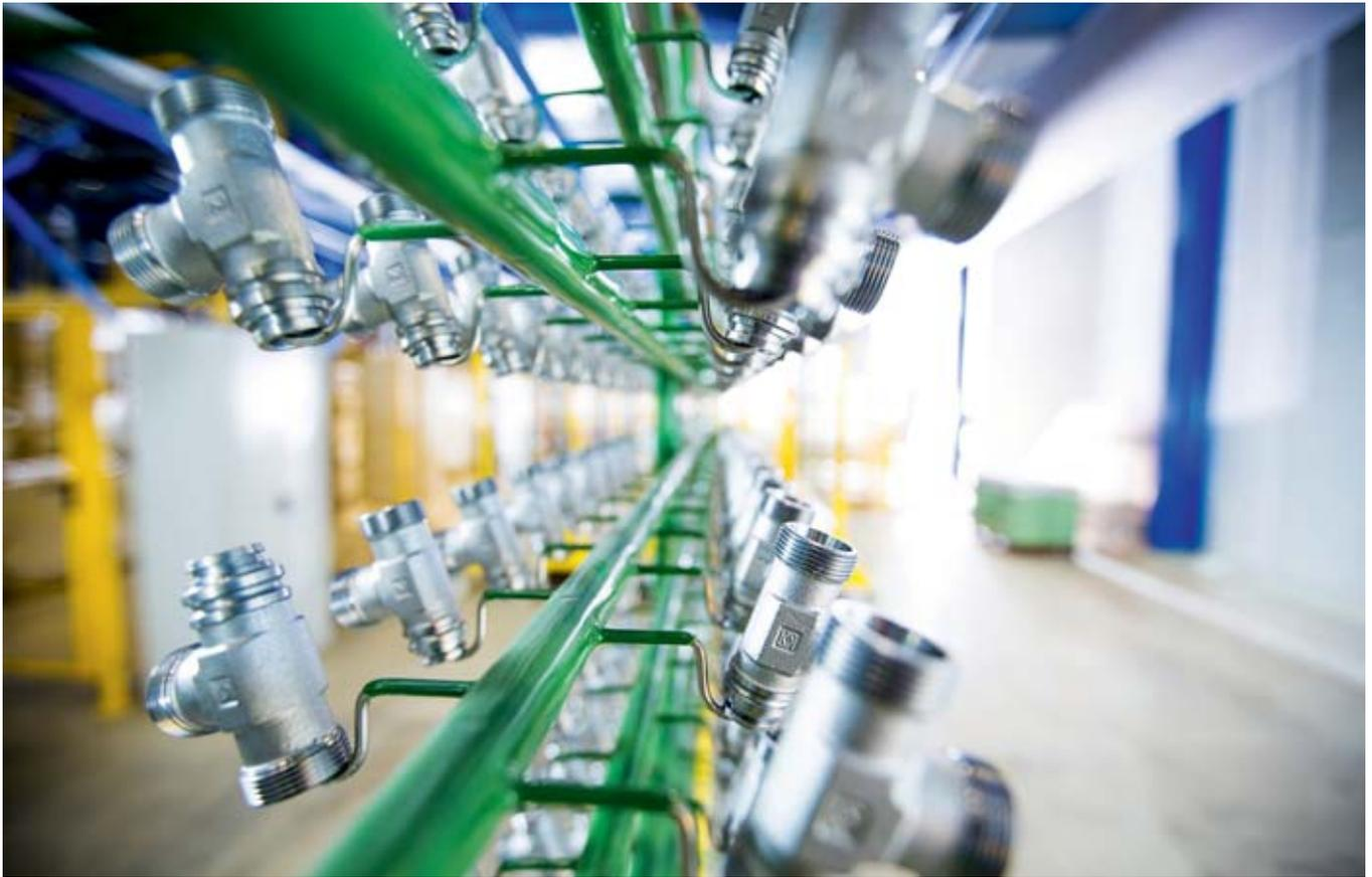
Das Schmiermittel ist in die Stauff Zink-/Nickelbeschichtung integriert.
