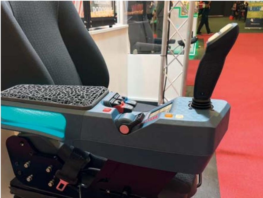
Die Armlehnen von Ibl Hydronic werden ergonomisch und funktionell auf die Bedienung der jeweiligen Maschine abgestimmt. Additive Fertigungs- und Post-processing-Technologien erlauben, kleine und mittlere Serien ressourcenschonend zu fertigen.
