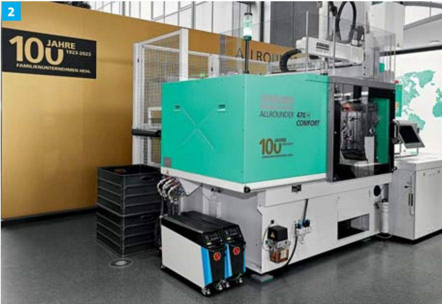
Technologie passt sich das Antriebssystem über einen drehzahleregelten, wassergekühlten Servomotor stufenlos an den tatsächlichen Leistungsbedarf an. Großer Vorteil dabei: Bei Stillstand der Maschine steht auch der Pumpenantrieb, sodass es keine Leerlaufverluste mehr gibt.
