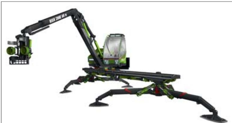
In dem aktuellen Forschungsprojekt ‚Portalschreitwerk als Fortbewegungsprinzip auf befahrungssensiblen Böden und zerklüfteten Untergründen‘ werden die mechanischen, hydraulischen und steuerungstechnischen Anforderungen des Bewegungsprinzips ‚Schreiten mit einem Portalschreitwerk‘ erforscht.
