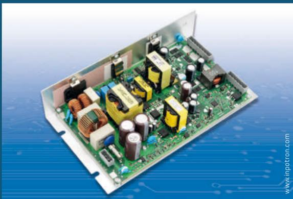
360-W-Netzteil für eine Industrieapplikation mit kundenseitig programmierbarer Ausgangsspannung von -12 bis +12 V: prozessorgesteuert und überwacht; für den Einsatz im Dauerbetrieb
