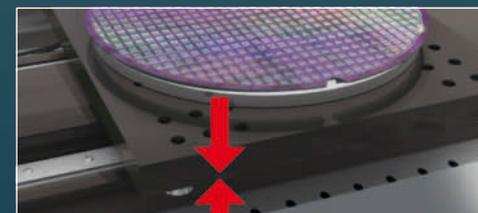
Positionierung der Waferstage
