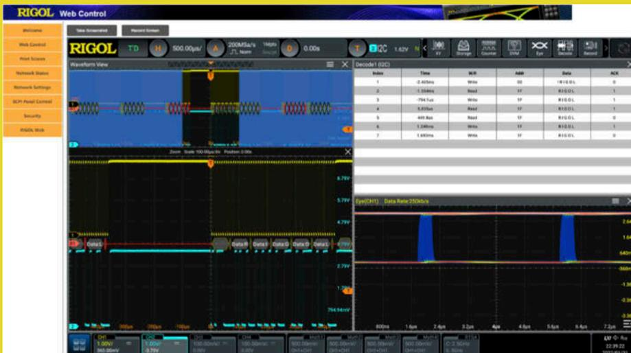
Die Web-Control-Oberfläche für die Darstellung und Bedienung des Oszilloskops
