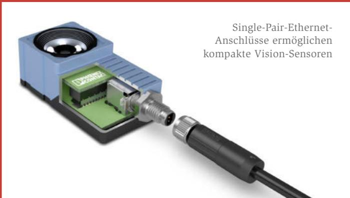
Single-Pair-Ethernet-Anschlüsse ermöglichen kompakte Vision-Sensoren
