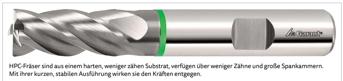
HPC-Fräser sind aus einem harten, weniger zähen Substrat, verfügen über weniger Zähne und große Spankammern. Mit ihrer kurzen, stabilen Ausführung wirken sie den Kräften entgegen.
