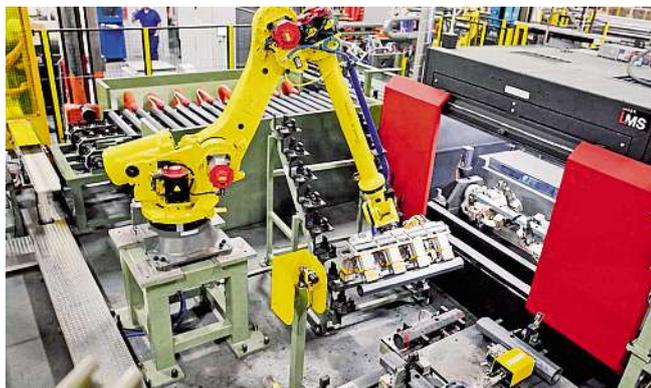
**68** Ethercat- und PC-basierte Automatisierung koordinieren bis zu fünf Schneidachsen.
