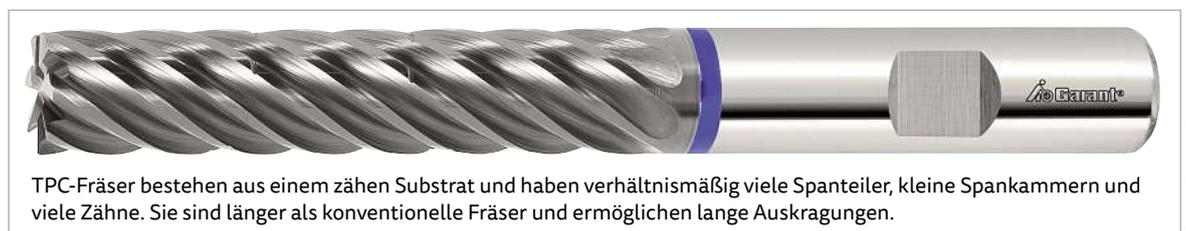
TPC-Fräser bestehen aus einem zähen Substrat und haben verhältnismäßig viele Spanteiler, kleine Spankammern und viele Zähne. Sie sind länger als konventionelle Fräser und ermöglichen lange Auskragungen.
