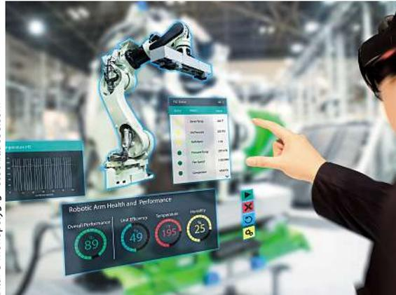
Augmented Reality ist eine der Schlüsseltechnologien für Remote-Service-Angebote, indem zentrale KPI der Anlage ortsunabhängig visualisiert und die Auswirkungen einer Anpassung simuliert werden können.
