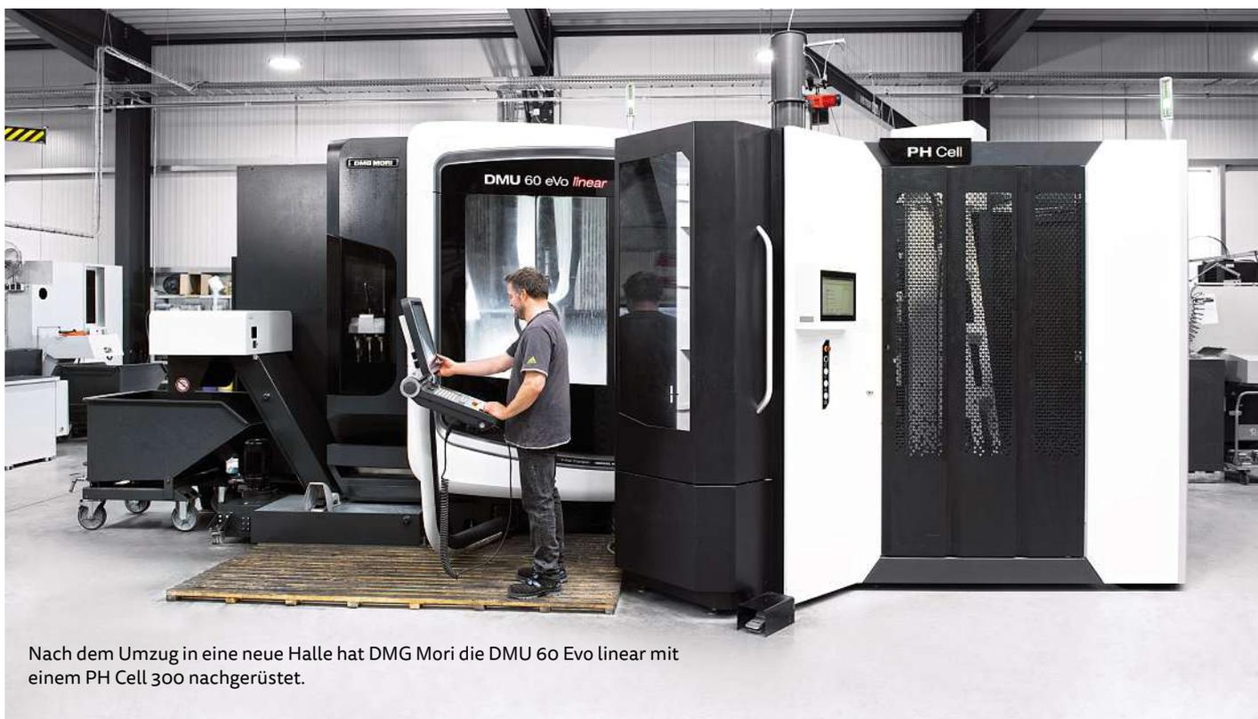
Nach dem Umzug in eine neue Halle hat DMG Mori die DMU 60 Evo linear mit einem PH Cell 300 nachgerüstet.
