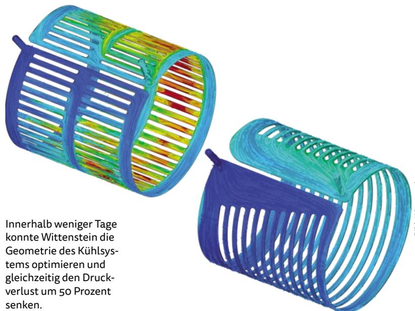
Innerhalb weniger Tage konnte Wittenstein die Geometrie des Kühlsystems optimieren und gleichzeitig den Druckverlust um 50 Prozent senken.
