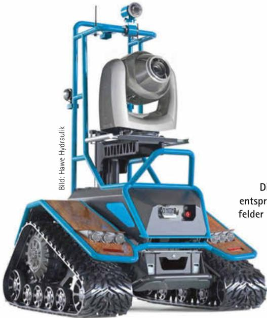
Die mobilen Roboter können entsprechend ihrer Anwendungsfelder angepasst werden. So lässt sich Rovo auch mit einem Kamerasystem ausstatten.
