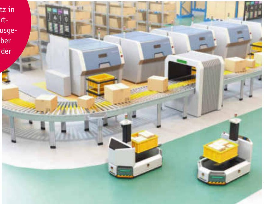
Fahrerlose Transportsysteme oder AGVs sind aus der Intralogistik nicht mehr wegzudenken und erfordern präzise Drehgeber. Zu den AGVs zählen auch mobile Roboter.
