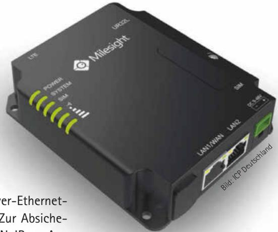
des UR32L ist mit Power-over-Ethernet-Funktionalität ausgestattet. Zur Absicherung können Features wie VPN, IPsec, Automated Failover und Fallback und SPI Firewall eingerichtet werden. Die Integration von Watchdog und Multi-Link-Failover-Erkennung sorgt ferner für eine stabile Kommunikation. Das IP30-Metall-Ge-
