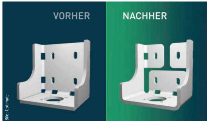
der Konstrukteur dann sein Biegebauteil so weit nachbessern, dass es auch auf seinen Biegemaschinen fertigbar ist.
