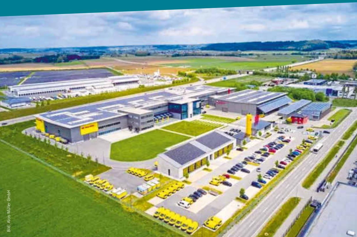
Die Green Factory der Alois-Müller-Gruppe in Ungerhausen ist nahezu energieautark. Die Energie kommt von einer Photovoltaikanlage, einem Blockheizkraftwerk und einer mit nachwachsenden Rohstoffen betriebenen Pelletheizung. Unterschiedliche Speichermedien gleichen mögliche Schwankungen in der Erzeugung aus.
