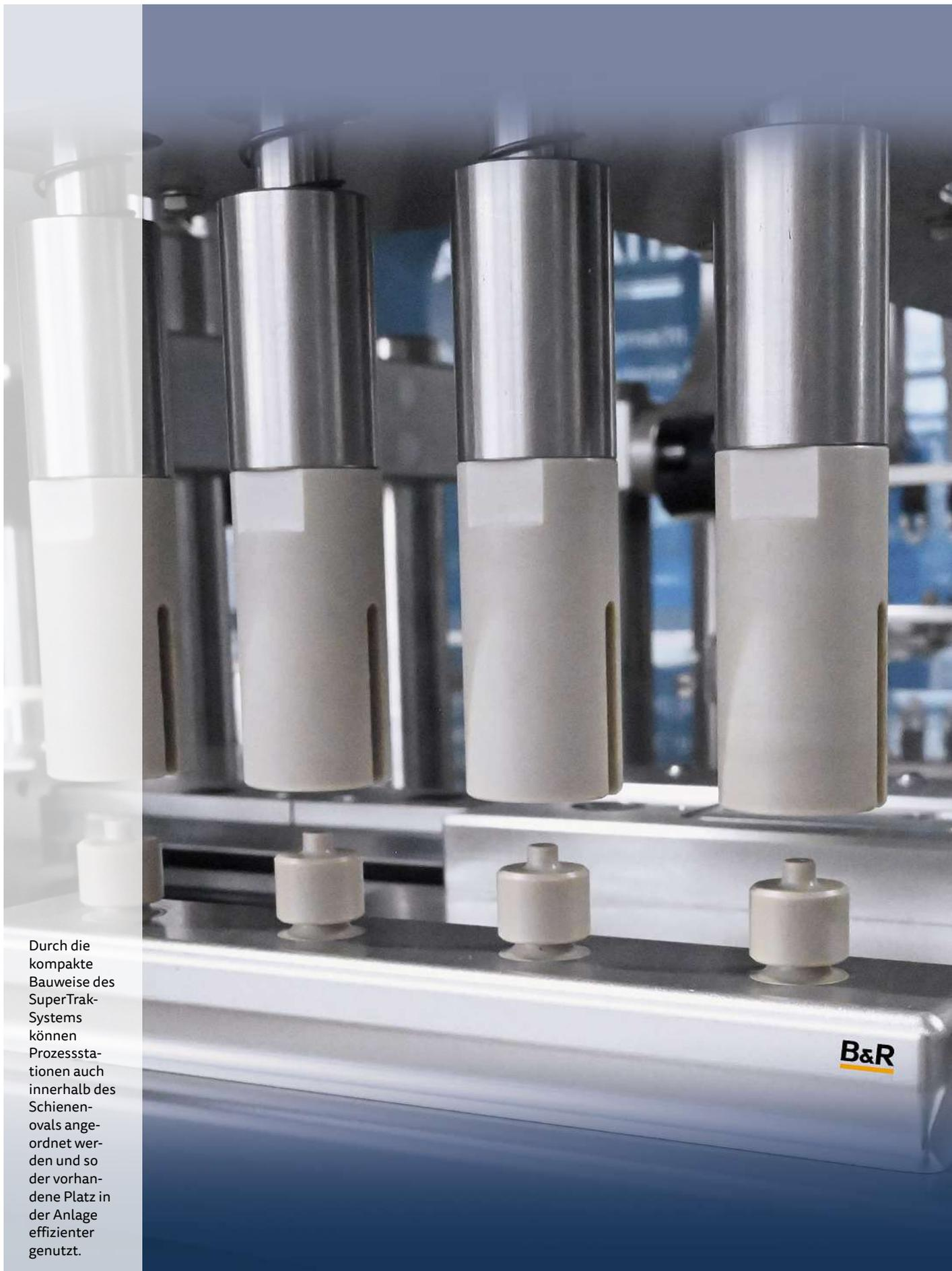
Durch die kompakte Bauweise des SuperTrak-Systems können Prozessstationen auch innerhalb des Schienenovals angeordnet werden und so der vorhandene Platz in der Anlage effizienter genutzt.
