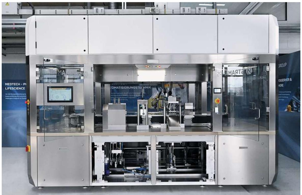
Die Demonstrationsanlage der ProMo-Curve besteht aus zwei Eckmodulen und einem Linearmodul (im Bild mit entfernten Frontabdeckungen).
