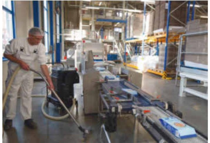
Typisches Beispiel für den Einsatz eines mobilen Staub-Ex-Saugers, hier in der Lebensmittelproduktion.
