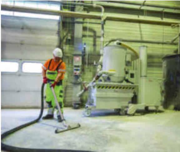
Für das Aufsaugen großer Sauggutmengen stehen eigene Saugerbaureihen zur Verfügung.
