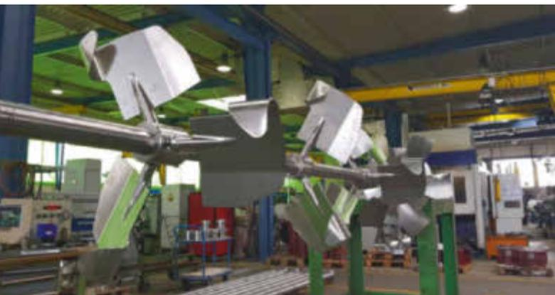
Bild 4: Typische Anordnung der Rührer in der Fertigung
