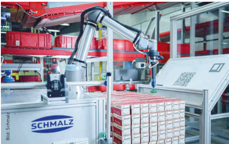
Schmalz lieferte den Bin-Picking-Greifer SBPG mit drei Saugern aus. Der Cobot wählt automatisch die zur Kartongröße passende Variante.
