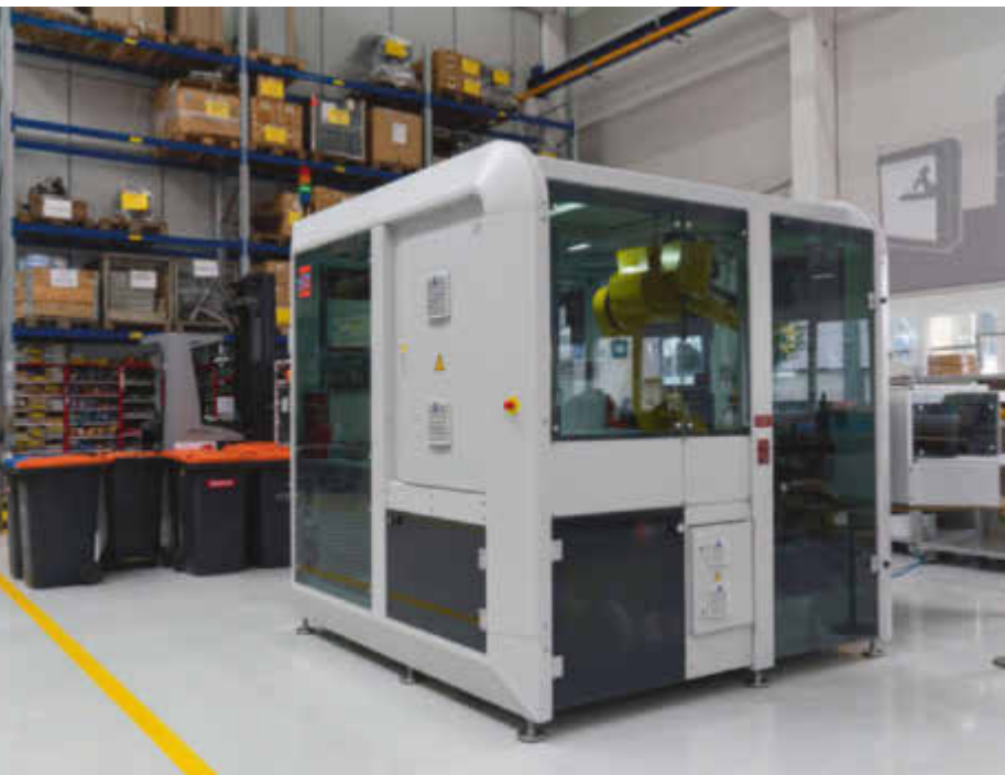
Gesamtansicht der Roboter-Palettierzelle bei Wago.
