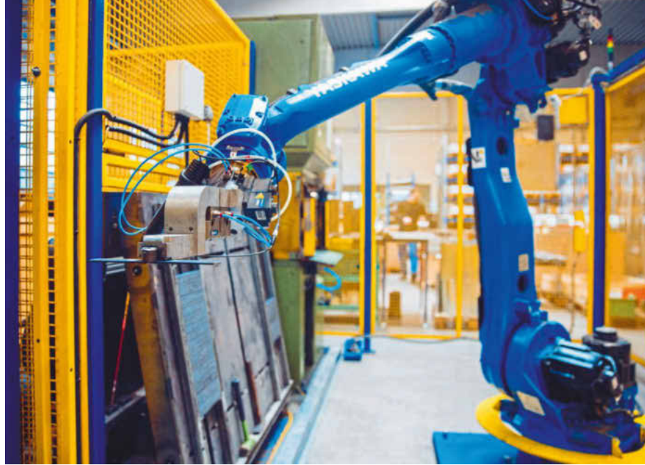
Schon seit 2015 übernehmen drei Roboter aus der Motoman-MH-Reihe von Yaskawa bei Rohrbefestigungen Hammerschmid unterschiedliche Handlingaufgaben.
