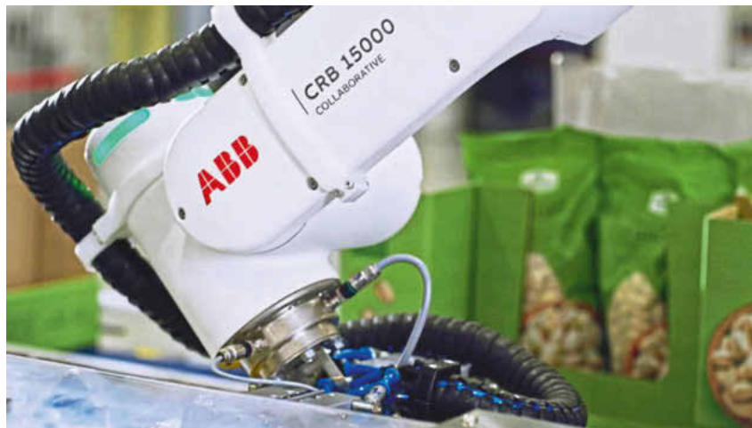
Mit der Roboter-Anwendung zur Umfüllung von Beuteln mit Nüssen in Kartons steigert der Verpackungsbetrieb Dan D Pak den Durchsatz und entlastet die Mitarbeitenden.
