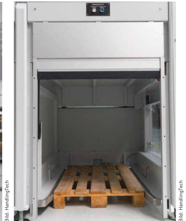
Geöffnete Palettenbucht mit Trennschott für den hauptzeitparallelen Wechsel der Paletten.
