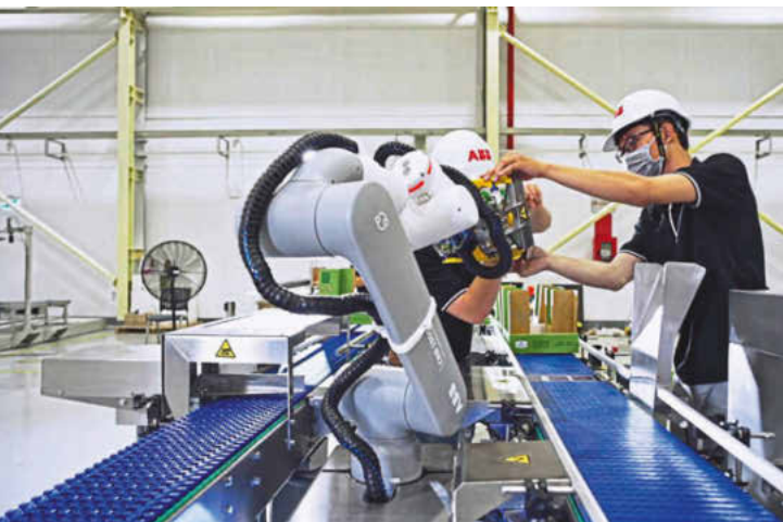
Seite an Seite mit den Mitarbeitenden übernimmt der ABB-Cobot Gofa Beutel mit Nüssen aus der Verpackungslinie und legt sie schnell und automatisch in Kartons um.
