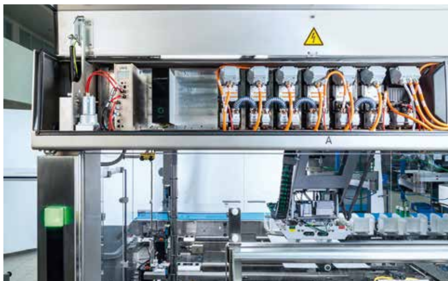
Alle neuen Schubert-Maschinen sind mit dem Industrial Gateway GS.Gate ausgestattet. Auf dem Gateway werden die Maschinendaten ähnlich dem Edge-Computing gesammelt und auf Wunsch im Kundenportal ausgespielt
