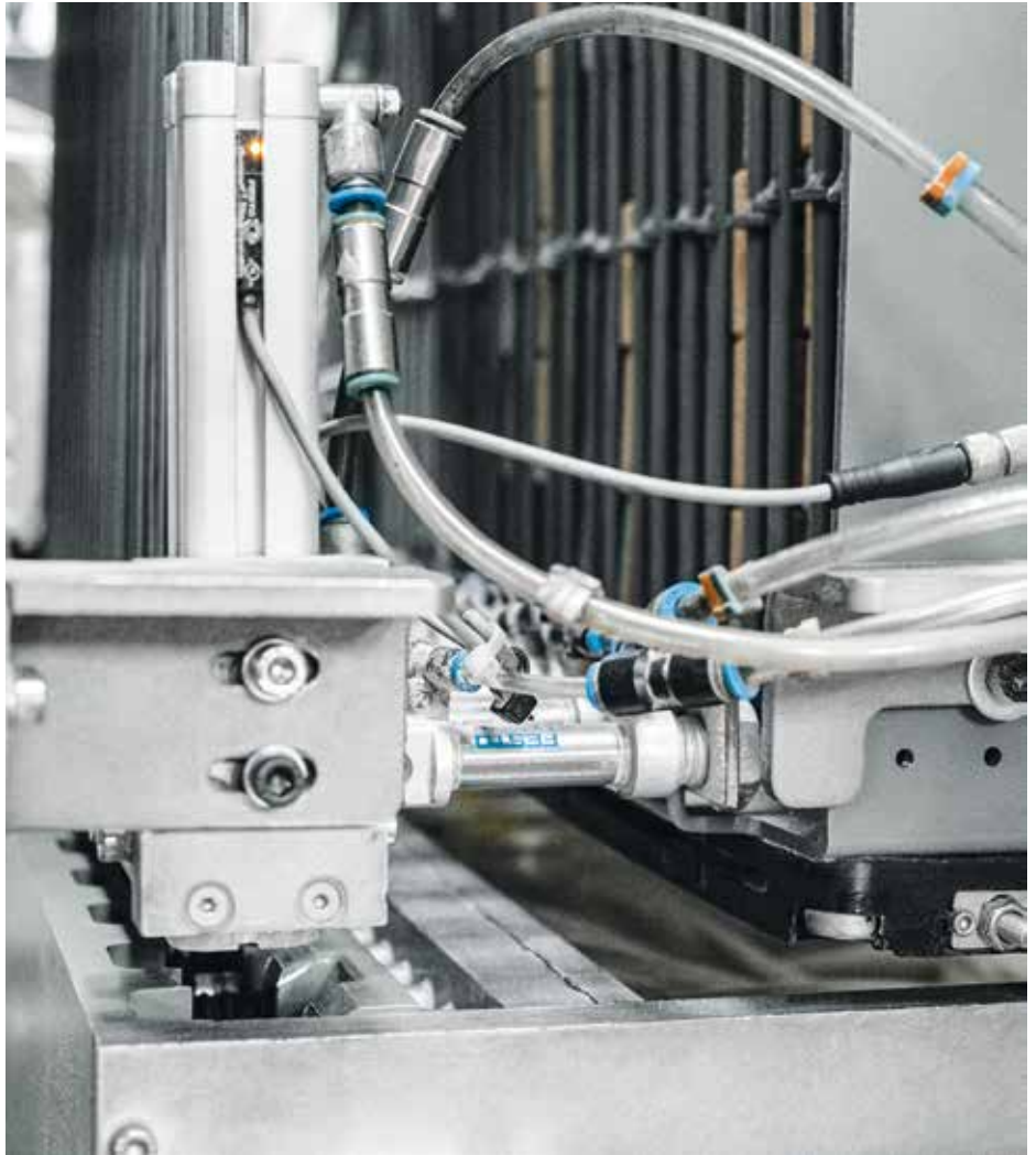
Robust: Die 20 DSNU Rundzylinder aus dem Kernprogramm von Festo drücken die Korken zusammen, während sie von den Vakuumsaugern angesaugt werden
