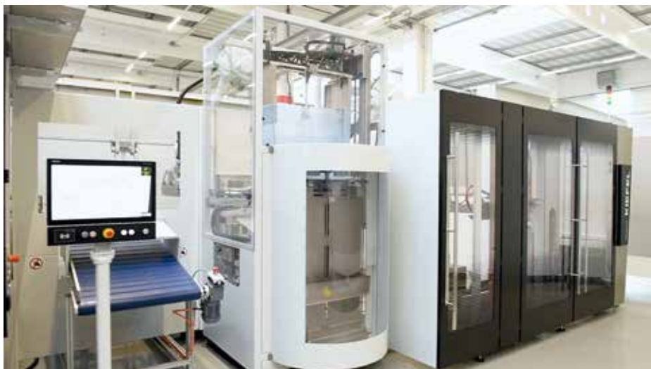
Module der KSA, wie hier der Beuteleinleger oder Kartonverschließer, können an bestehende sowie neue KMD-Maschinen angeschlossen werden
