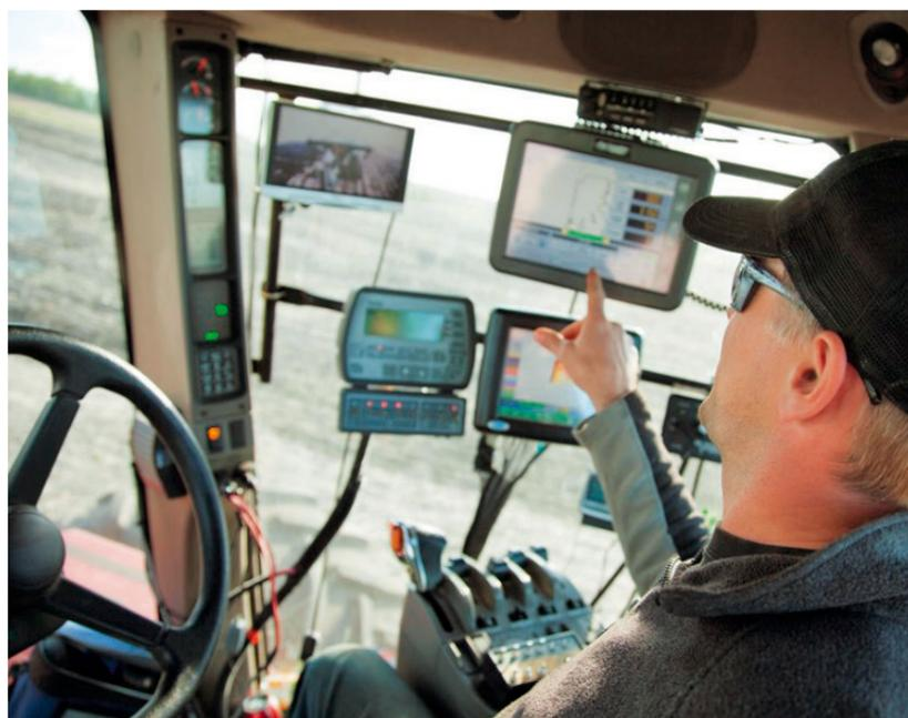
Die Displays sind speziell entwickelt für extreme Umgebungsbedingungen im Außenbereich. Das Display-Design mit hoher Helligkeit bis 1.100 cd/m<sup>2</sup> und hohem Kontrast von 900:1 sorgt für eine hervorragende Ablesbarkeit bei direkter Sonneneinstrahlung. Die Displays sind UV-geschützt.
