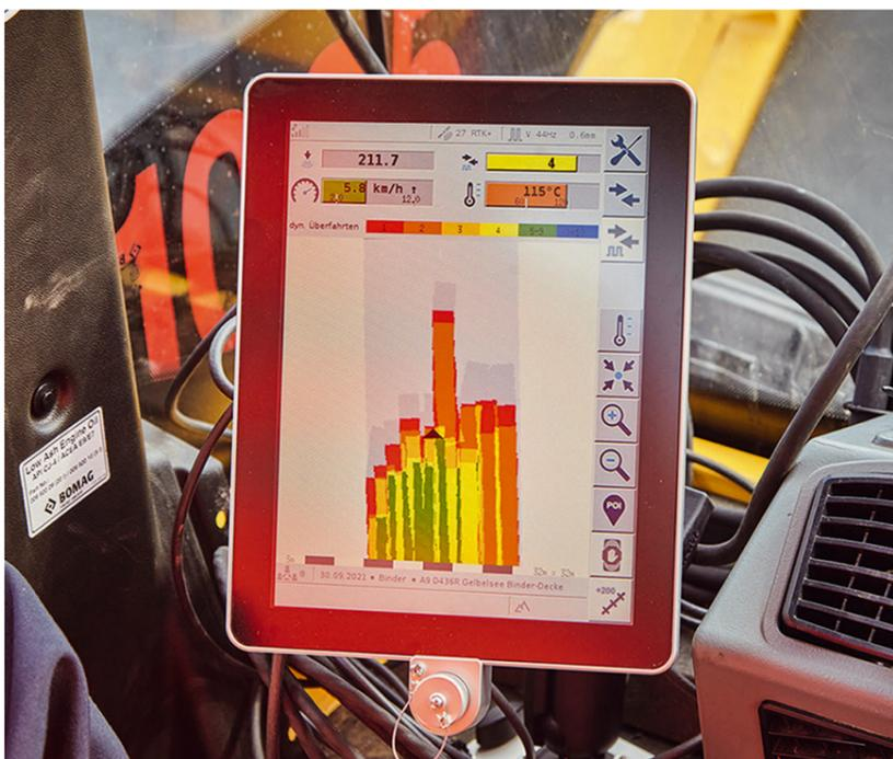
Der FDVK-A-Navigator unterscheidet sowohl zwischen statischer und dynamischer Verdichtung als auch zwischen Vibration und Oszillation. © VÖLKE Mikroelektronik
