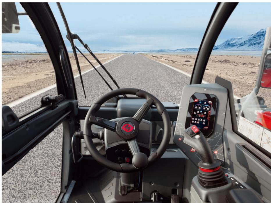
Alles klar: Die großflächige Frontscheibe im Magni-Cockpit sorgt für optimale Übersicht in jeder Hebesituation. Über ein hochauflösendes Display von Würth Elektronik ICS sind alle Funktionen des Combi Touch Systems gut erreichbar. Der Touchscreen ist in robuster Full-Bonding-Technik ausgeführt. © Magni
