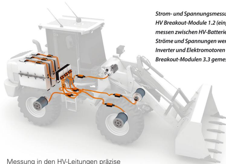
**Strom- und Spannungsmessung im HV-Bordnetz: HV Breakout-Module 1.2 (einphasige Messung) messen zwischen HV-Batterie und Inverter. Ströme und Spannungen werden zwischen Inverter und Elektromotoren dreiphasig mit HV Breakout-Modulen 3.3 gemessen.** © CSM
