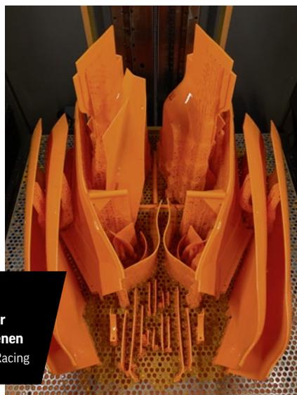
barkeit fertigen. Tim Chapman, Leiter der Additiven Fertigung bei McLaren Racing, erklärt: „Die produzierten Komponenten erfordern nur minimale manuelle Nachbearbeitung, was einen viel schnelleren Durchsatz im Windkanal ermöglicht. Die Zeiten für das Finish wurden drastisch reduziert.“
