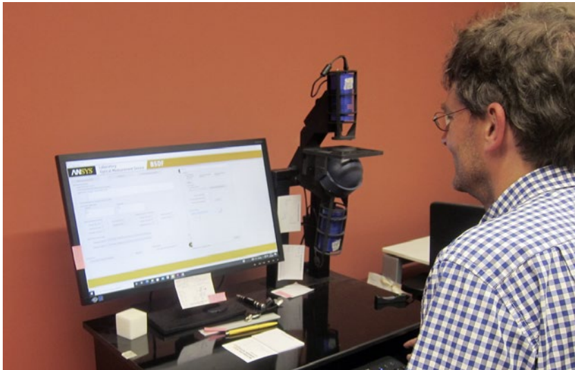
Matthias Noak, Leiter des Optiklabors, bereitet am Leitrechner eine ausgeführte Streulichtmessung auf – eines der Hauptbestandteile des Materialmodells. Rechts neben dem Monitor, ein Spektrometer.
