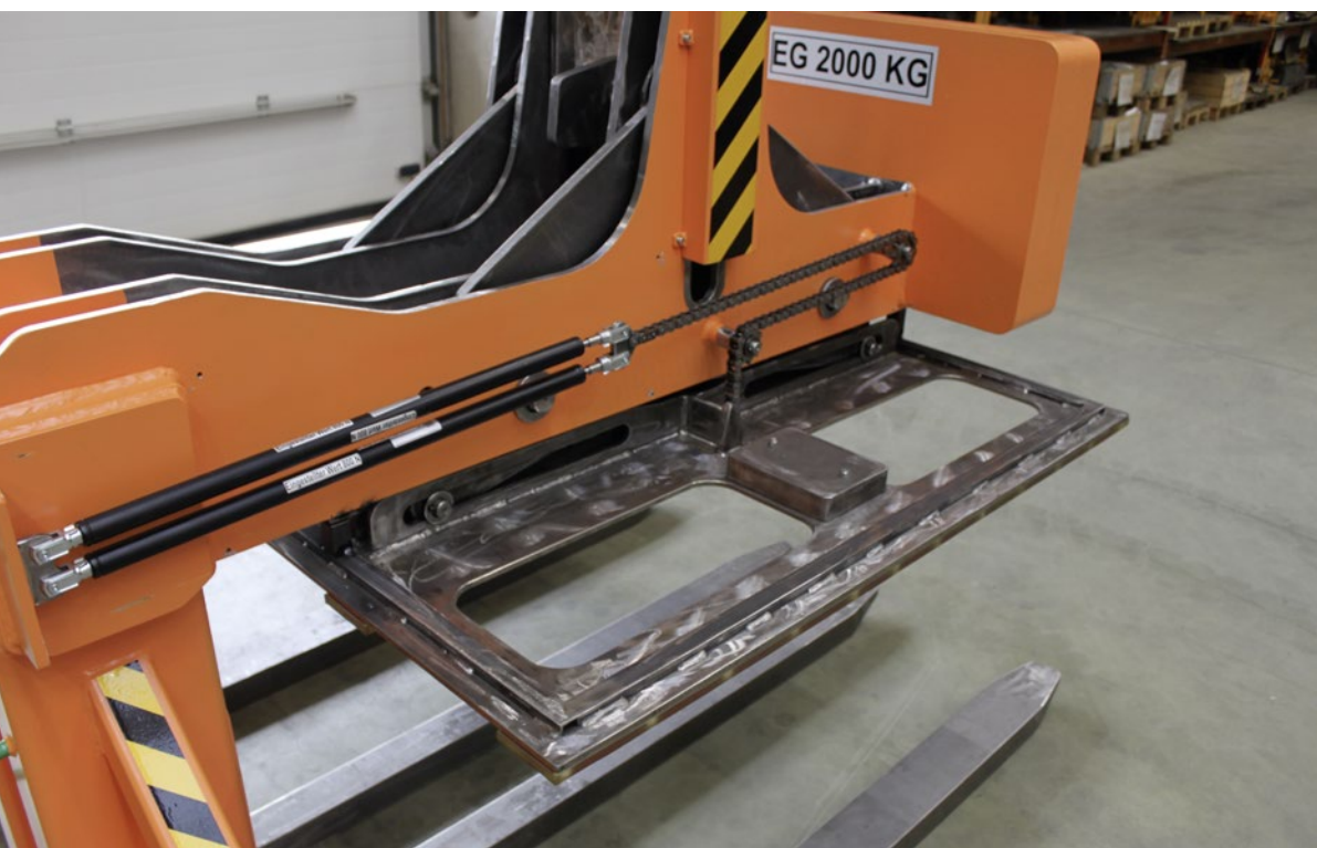
Dieser Platinengreifer mit Aufsetztisch hebt und transportiert gestapelte Blechzuschnitte.
