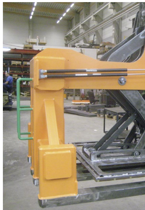
Dieser Platinengreifer mit Aufsetztisch hebt und transportiert gestapelte Blechzuschnitte.
