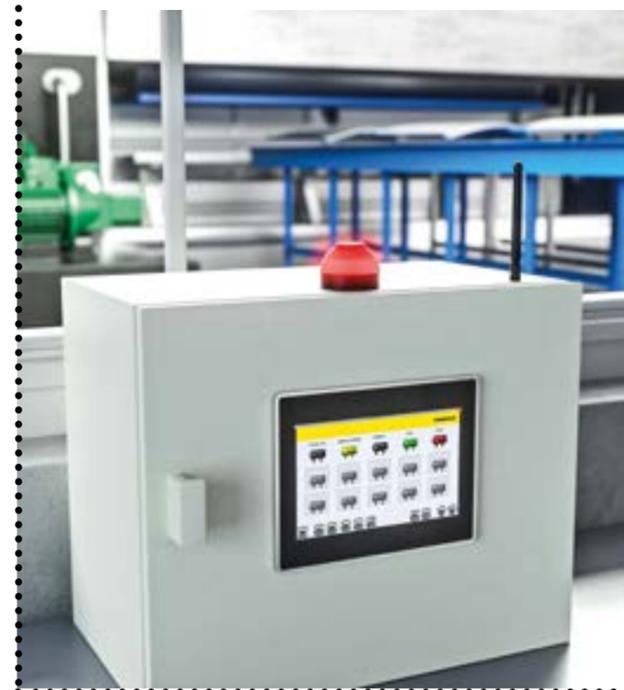
*Der Anwender hat alles im Blick, direkt vor Ort auf dem TX700 HMI/PLC oder per Cloud-Lösung auch auf mobilen Endgeräten.*
